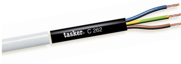
■ Cavi multipolari flessibili per energia H05 VV-F 300/500 V, conduttori isolati in PVC, sotto guaina media in PVC. Per applicazioni fredde in locali domestici, cucine, uffici ed ambienti umidi. Adatti alla realizzazione di prolunghe e multiprese elettriche per il collegamento di piccoli e medi elettrodomestici, utensili elettrici domestici, ed altre applicazioni soggette a sollecitazioni meccaniche di media intensità. **Disponibile in 2 diversi colori**
