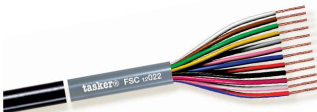
Cavo multipolare flessibile composto da singoli conduttori avvolti tra di loro, per cablaggi all'interno di quadri comando, pannelli a led, schede, strumenti di misura, PC, modellismo ed elettronica in genere. Gli isolamenti in PVC ne consentono l'uso solo per applicazioni fredde e di bassissima tensione.
