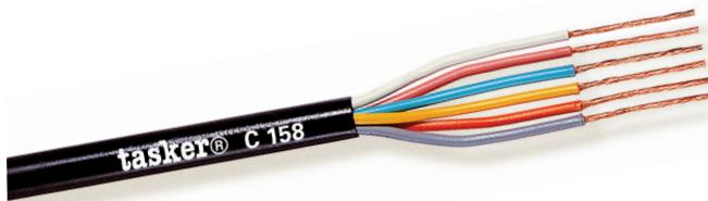
ITALY Cavi multipolari flessibili inguinati per cablaggi all'interno di quadri comando, pannelli a led, schede, strumenti di misura, PC, modellismo ed altre applicazioni fredde elettroniche. Isolamenti in PVC.
